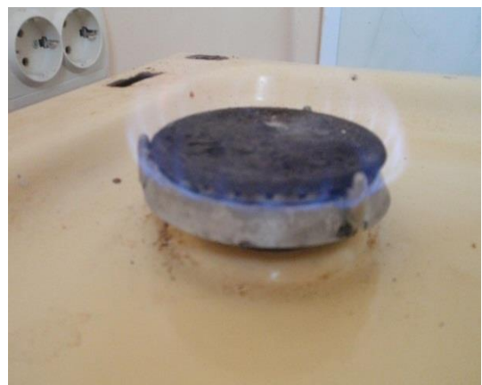
Рис. 10. Програма Європейського Союзу «Горизонт 2020». Утворення біогазу модульною системою газогенератора, демонстрація отриманого газу на стандартній конфорці
